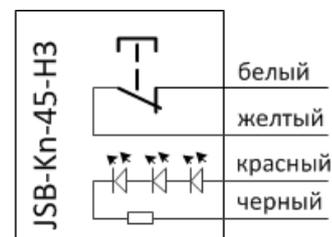
**Внимание!** При непосредственном управлении электромеханическим замком необходимо использовать дополнительный защитный диод, рассчитанный на ток 2А (например 1N5400), который подключается параллельно выводам замка катодом к “+” источника питания.
